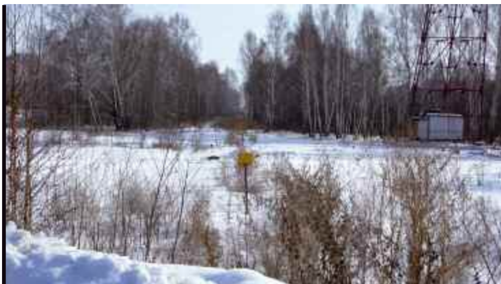
1 Столбики-аншлаги определяют границы охранной зоны линейного объекта по 2 м от оси кабеля
