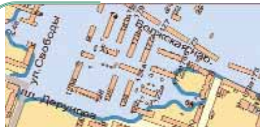
Рис. 6. Моделирование затопления на расчетную высоту отметку
