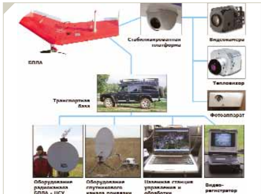
Рис. 5. Состав беспилотного авиационного комплекса
