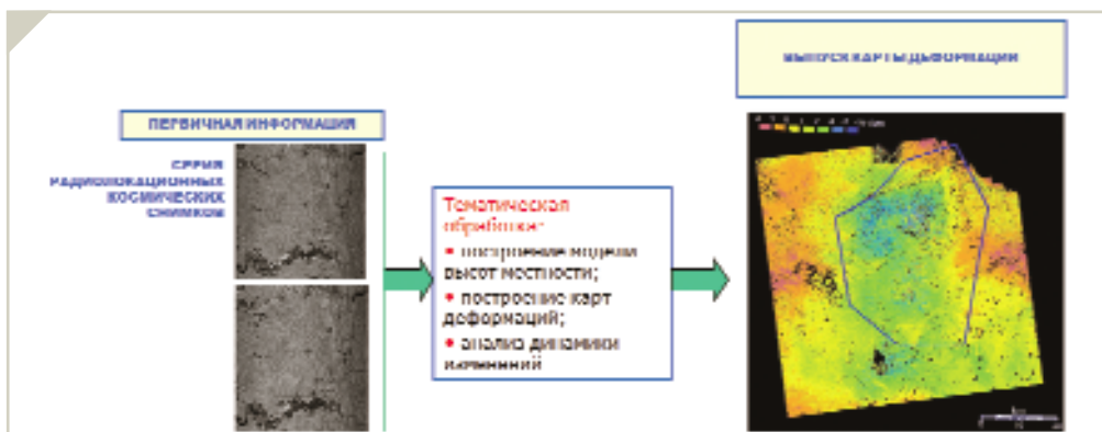
Рис. 8. Схема методологии измерения деформаций земной поверхности
