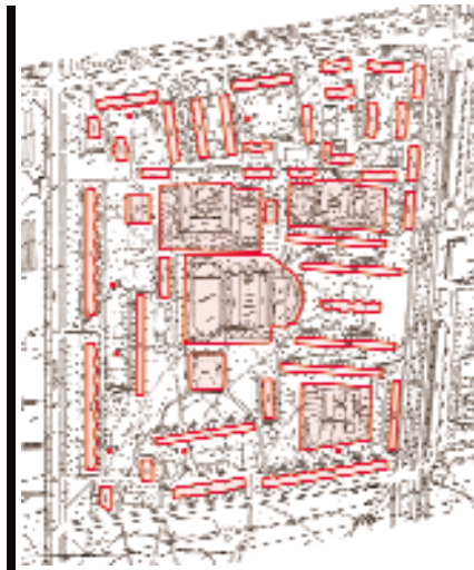
3 Пример абсурдного отображения красных линий, когда земельные участки домов установлены по обрезу фундамента
